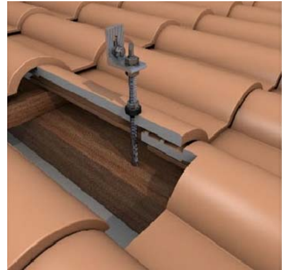
DETALLE ANCLAJE EN CUBIERTA DE TEJA
